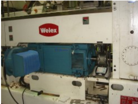
Uitlijning van een kunstofextruder na een kleine revisie.
